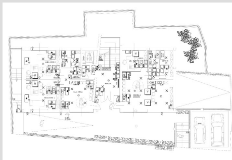
PIANO TERRA IMPIANTO ELETTRICO
